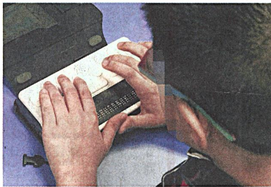
▲布莱叶点字法记事本，是视障人士的随身笔记本，用布莱叶点字法输入，就能转换成音效，读出所输入的文字。
